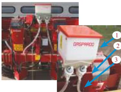
Рис. 1 Емкость для гранулята: 1 — емкость (бак) для гранулята, 2 — регулируемые катушки дозирующего аппарата, 3 — тукопровод
