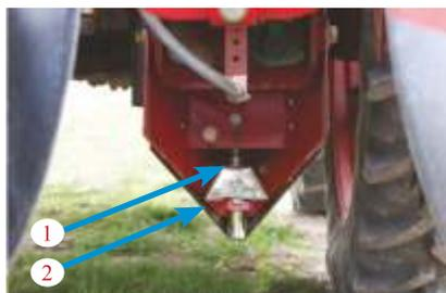
Рис. 2 Распределительное устройство в сошнике: 1 — тукопровод, 2 — распределительное устройство
